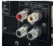
最終出力段となるスピーカー端子には、バナナプラグに対応した大型スクリー端子を採用。さらに、音楽信号の伝送ロスを防ぐため、金メッキ化を図っています。
