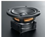
入力信号に対する応答性を高めるために、エッジの高さと幅を拡張したスライエッジを採用。振動板には不要振動を抑える多層コーティング素材を、キャップ部には高域共振を持たず歪み特性に優れたポリウレタン素材を採用しています。また、新規開発フレームには、エアコントロールホールを設け、ウーファースのスムーズな振幅を可能としています。しかも、フレーム素材に樹脂素材を採用することで、磁束漏れを低減し、固有共振を抑えます。
