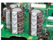
コンデンサーにはより多くの電力を蓄えることができる、ケンウッドオリジナル大容量アルミ電解コンデンサーを使用しました。常に安定した電源供給を行い、特に低域の量感を大幅に向上させています。
