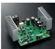
通常ひとつの放熱器で兼用される、アンプ用放熱器と電源用放熱器をそれぞれ独立させました。分離配置することにより、互いの干渉を排除。効果的な放熱を行うことで、音質への影響を最小限に抑えます。
