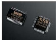
プリアンプ部には、伝送ロスや外来ノイズの影響を抑え、高精度な信号変換を可能とする、フルデジタルプリアンプを採用。D.P.A.C. (Digital Pulse Axis Control) 回路を搭載し、ジッター(時間軸のズレ)を抑制しながら、デジタル波形を整えます。そして、D/A コンバーターには歪性能に優れたWolfson社D/A コンバーターを採用。高精度マスタークロック発振器による時間軸の管理と、専用巻き線による安定した電源供給により、変換精度を高め音楽データに忠実な信号変換を実現します。
