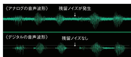
《上図》アナログでは残留ノイズにより音声が埋もれ、聞き取りにくくなります。
